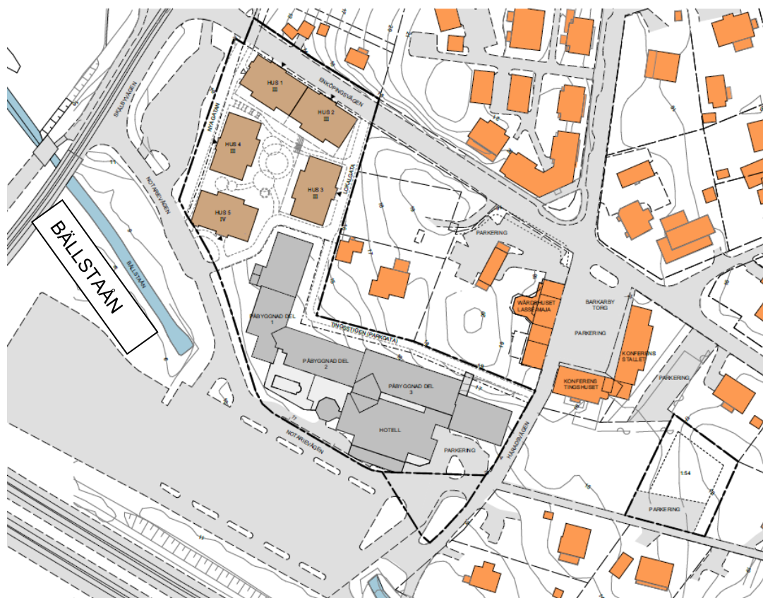
Figur 1-1. Situationsplan (2020-06-27) med mörkgrå befintliga byggnader som bevaras inom planområdet och bruna nya byggnader. Befintliga byggnader utanför plangränsen illustreras som orange.
