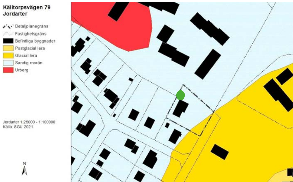
Figur 10: Jordartskarta från SGU, område med berg i dagen redovisas med en grön punkt
