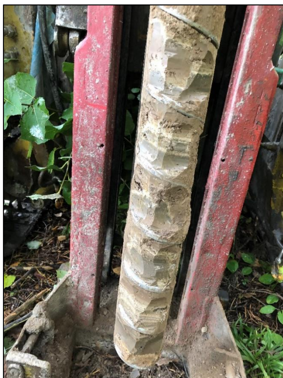
Figur 7. Skruv från 19GS31 0-1 m. Jordarterna utgjordes av siltig torrskorpelera från ca 0,3 meters djup.
