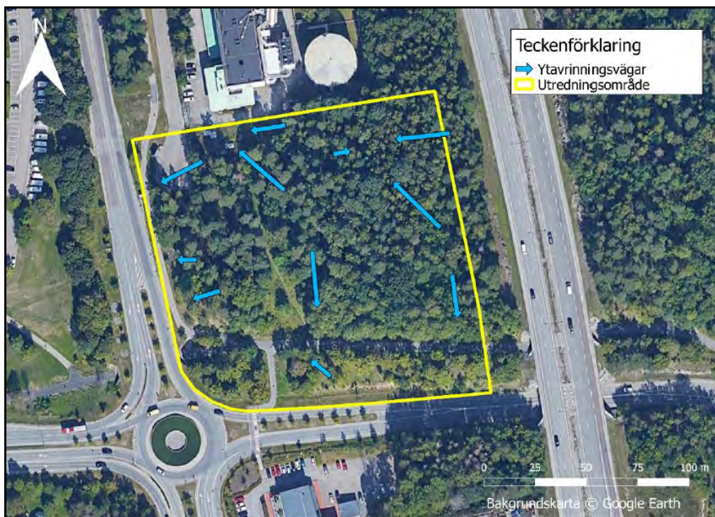
Figur 5.19 Ytavrinning/flödesriktning av dagvattnet från planområdet. Utdrag från Dagvattenutredning Jakobsberg 18:19 (Geosigma AB, 2019c).
