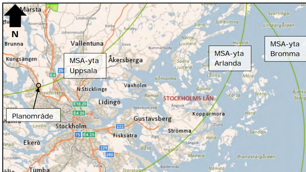
Figur 5.43 Karta över riksintressen för flyg och områdets närmaste flygplatsers Minimum Sector Altitude (MSA)-ytor (gröna linjer) (Trafikverket, 2020b).
