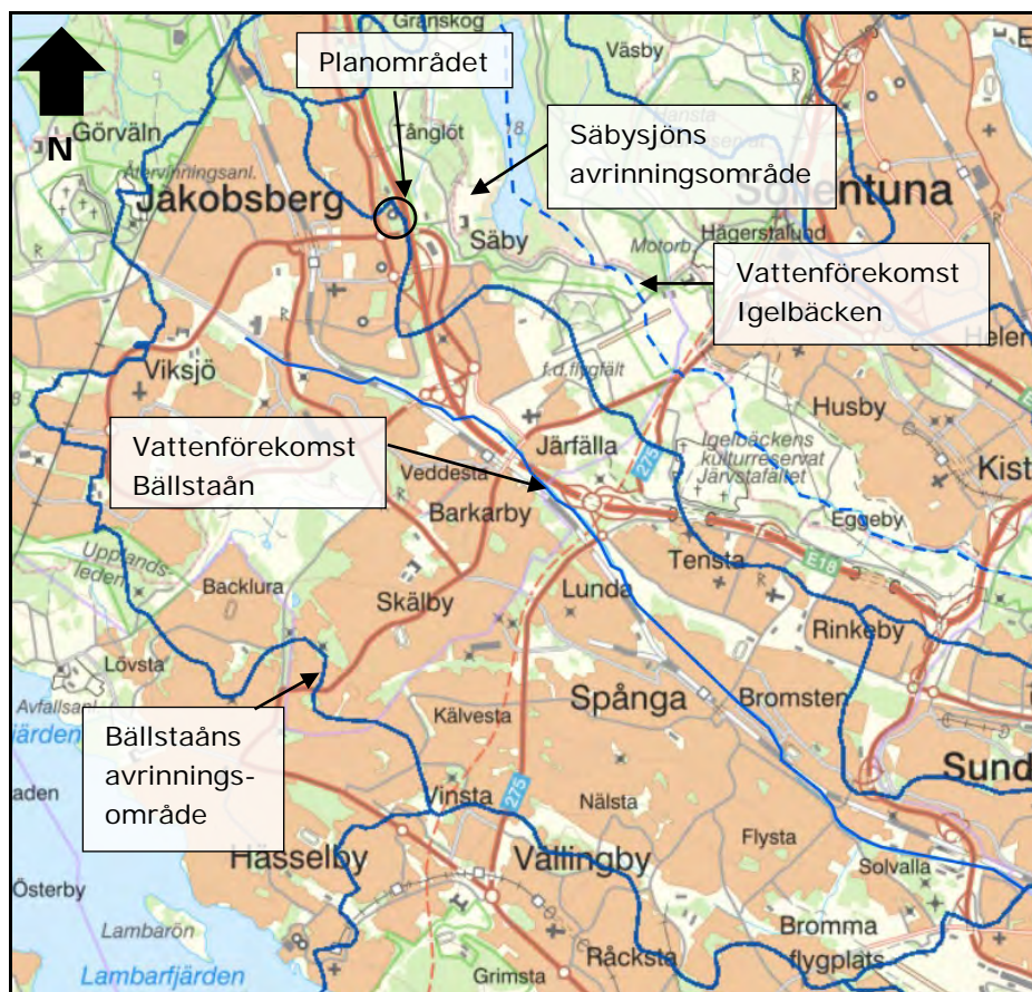
Figur 5.16 Vattenförekomst Bällstaån (blå hel linje) och dess avrinningsområde (inom mörkblå hel linje), samt Säbysjöns avrinningsområde (inom mörkblå hel linje) och vattenförekomst Igelbäcken (blå streckad linje), i förhållande till planområdets lokalisering (svart cirkel) (Vatteninformationssystem Sverige, 2020a).
