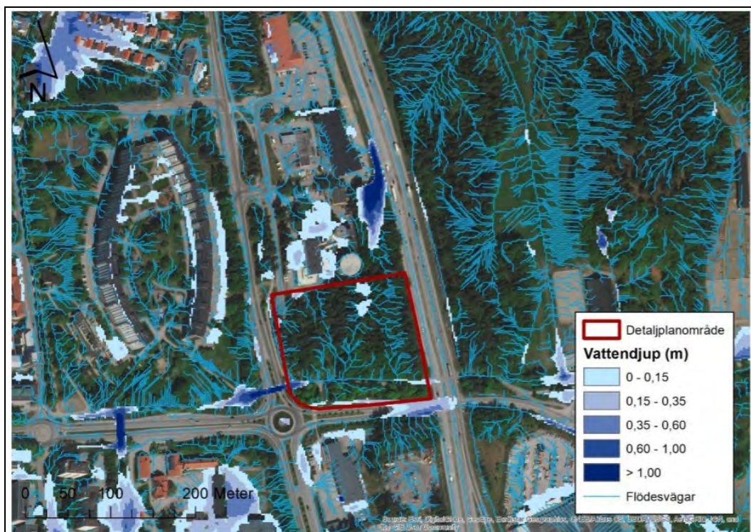
Figur 5.42 Lågpunktskartering och rinnvägsanalys befintlig situation med 100-årsregn (Geosigma AB, 2021). Två lågpunkter finns och vattnet rinner söder och väster ut från planområdet.
