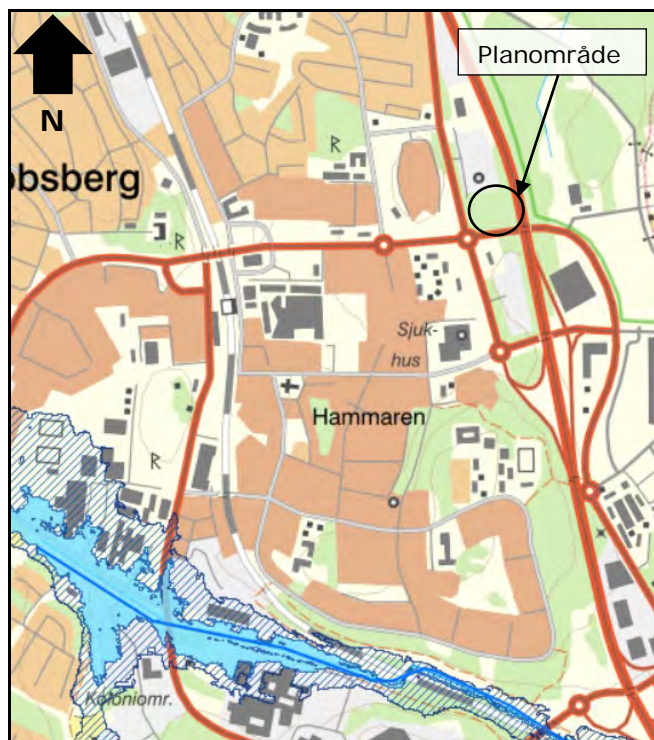
Figur 5.40 Områden som skulle översvämmas vid 100-årsflöde, 200-årsflöde samt beräknat högsta flöde (Myndigheten för samhällsskydd och beredskap, 2019a). Den blåa linjen motsvarar Bällstaån, den ljusblåa områdena kring ån motsvarar översvämning vid 200-årsregn och de mörkare streckade blåa ytorna motsvarar de områden som förväntas hamna under vatten vid en översvämning som motsvarar ett tänkbart värsta scenario som kan inträffa på grund av naturliga faktorer.
