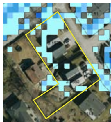
Figur 4: Översvämningsrisk vid ett klimatanpassat hundraårsregn.
