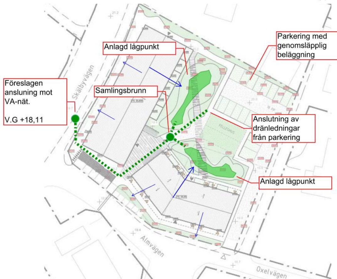
Figur 10. Principförslag för framtida dagvattenhantering inom området. Blå pilar visar avrinningsriktning från taktytor.
