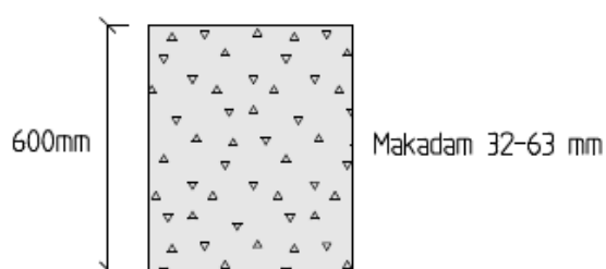
Figur 14. Principsektion för krossmagasin för gator inom delavrinningsområde 3 med dimensionerande tjocklek på dess filtermaterial.
