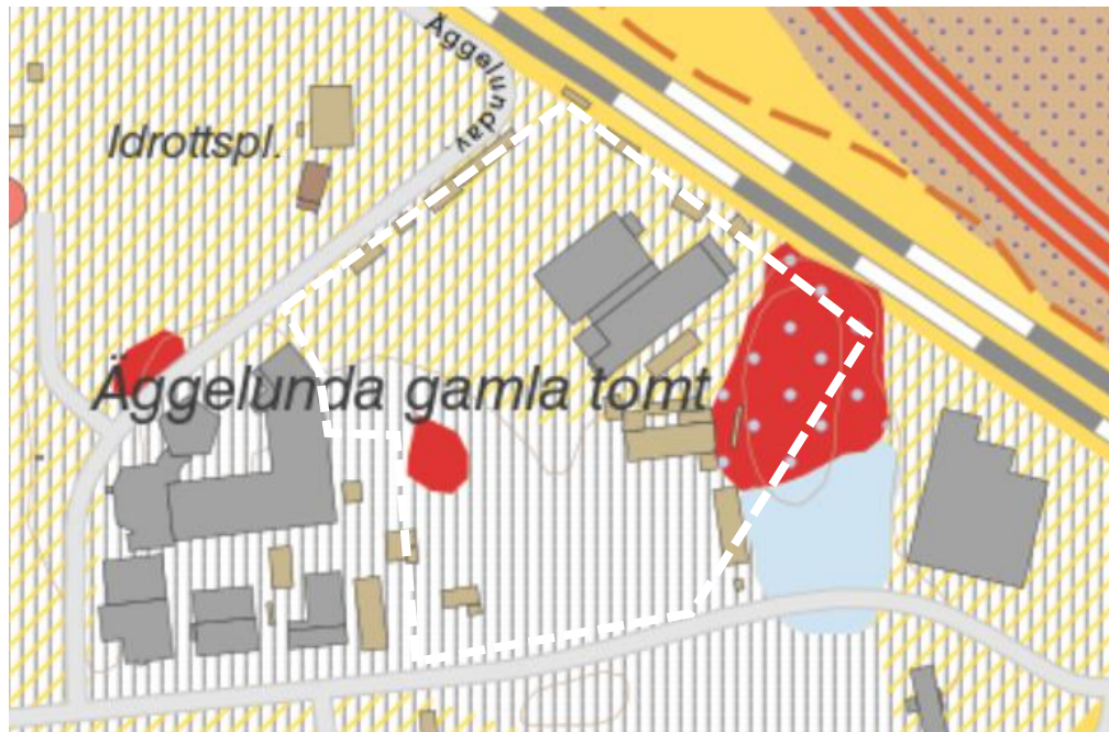
Figur 6: Jordarter i området. Vitt är fyllning, Gult är lera, ljusblått är morän och rött är berg i dagen.
