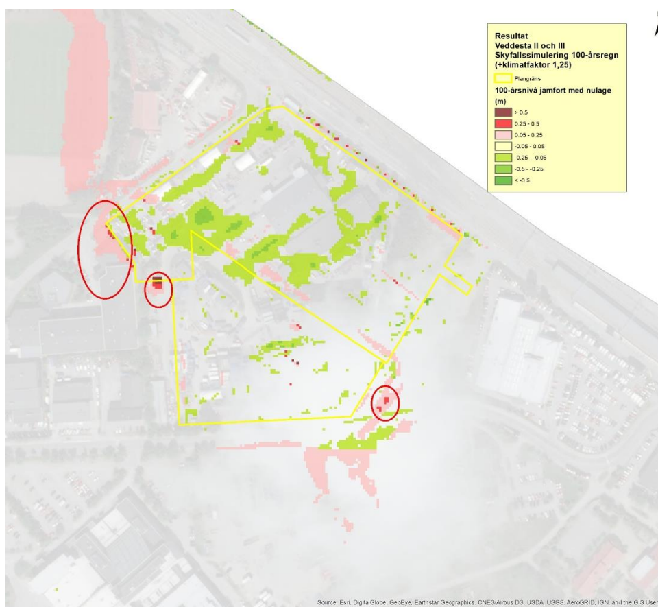
Figur 9. Beräknat maximalt översvämningdjup jämfört med nuläge. Rött innebär större vattendjup, grönt innebär mindre vattendjup jämfört med nuläge. Punkter med ev. negativa konsekvenser har markerats (röd ring).
