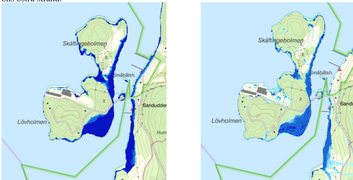
Figur 20: Bilden till vänster visar beräknat högsta flöde (BHF) och bilden till höger visar ett klimat-anpassat 100-årsflöde.
