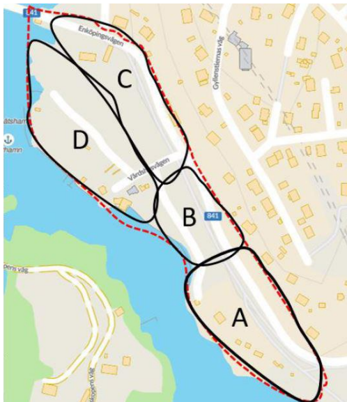
Figur 3-7 I områden A och C är markförhållandena goda. I områden B och D krävs åtgärder för att undvika sättningar och jordskred. 11
