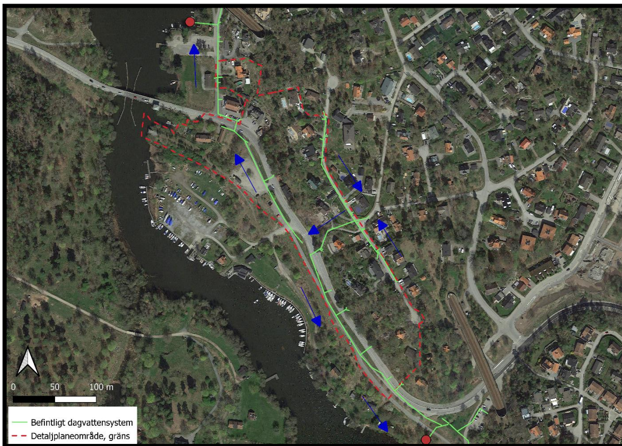
Figur 2. Befintligt dagvattensystem och flödesriktning (blåa pilar), samt utsläppspunkter (röda prickar) norr och söder om området.
