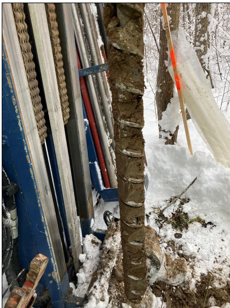
Figur 5-1. Jordskruv med torrskorpelera från provtagningspunkt 22GS03, 1–2 m.
